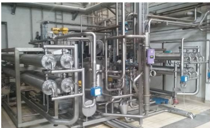
Figure 15 : Dispositif de concentration du lactosérum de l'Union laitière vittelloise permettant une réduction de prélèvement de 25 000 m 3 /an dans une ressource en déséquilibre quantitatif
